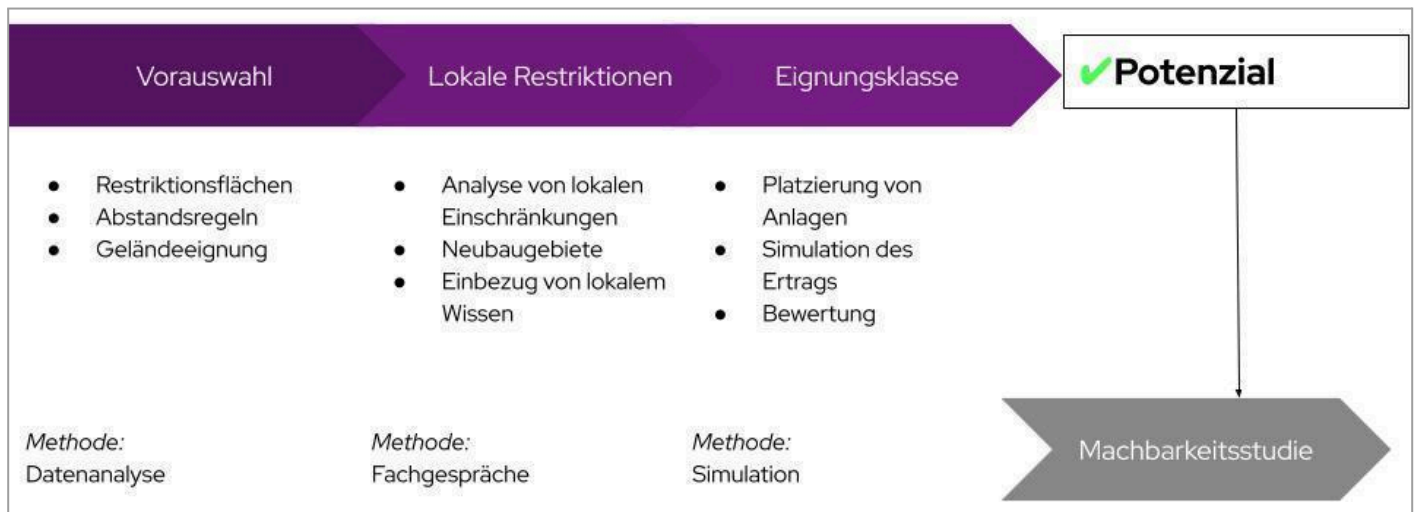
Abbildung 16: Vorgehen bei der Ermittlung von erneuerbaren Potenzialen
